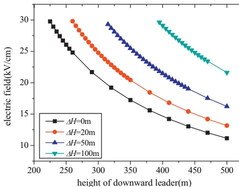
(d) Ground wire 2 (Considering the operation voltage)
